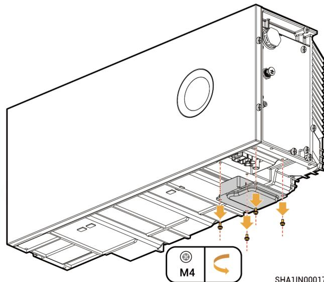
Schrauben wie in Schritt 5 beschrieben an der Verkleidung anbringen.
