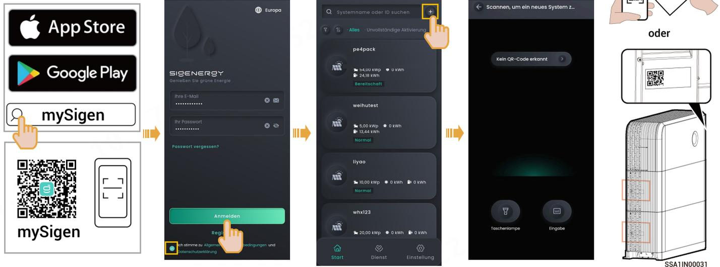
Scannen Sie die Seriennummer (SN) auf der mitgelieferten Verpackung. Alternativ können Sie auch die Seriennummer seitlich auf dem Wechselrichter oder dem SigenStor BAT scannen.
