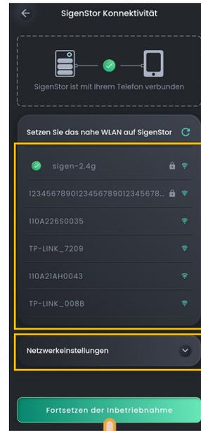
Wenn verbunden mit dem WLAN-Hotspot auf dem Gelände des Besitzers oder wenn die SIM-Karten-APN eingestellt ist (im Gerät ist eine SIM-Karte eingesetzt), klicken Sie auf "Weiter zur Inbetriebnahme", um zur Seite für die Erstellung eines neuen Systems zu gelangen. Sie können sich auf die Beschreibung des Abschnitts "Bereits mit dem Internet verbunden" beziehen.
