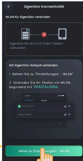
Verbinden Sie den WLAN-Hotspot des Geräts. Der Hotspot wird als SN-Code des Geräts benannt.
